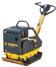
BPR 25/40 D Masa robocza: 150 kg Siła odśrodkowa: 25 kN Szerokość robocza: 400 mm
