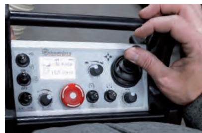
Zdalna obsługa sterowania trybu szlifowania i napędu
