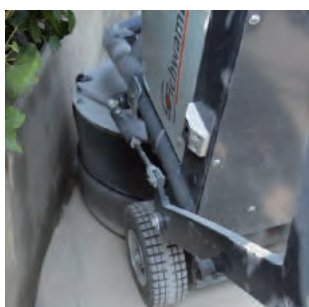
Szlifowanie blisko krawędzi za pomocą zdalnego sterowania
