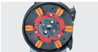
Jednakowy system mocowania narzędzi we wszystkich maszynach
