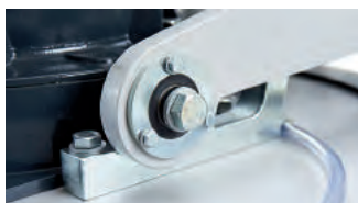
ADS: zawieszenie przekładni typu anti-szok
