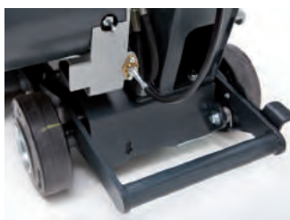
Dźwignia nożna do ustawiania w pozycji transportowej = szybkie przemieszczanie maszyny
