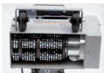
Zintegrowany frez krawędziowy
