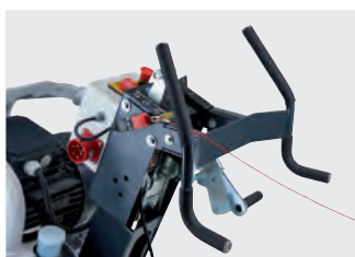
Uchwyt prowadzący z ochroną antywibracyjną = lepsza ergonomia
