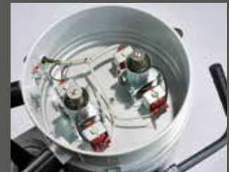
Automatyczne mechaniczne czyszczenie filtra
