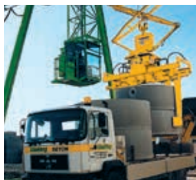
System transportu kręgów betonowych RKUS
