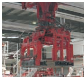
Hydrauliczny chwytek pakietujący z obrotowymi zaciskami – zakres obrotu 180°
