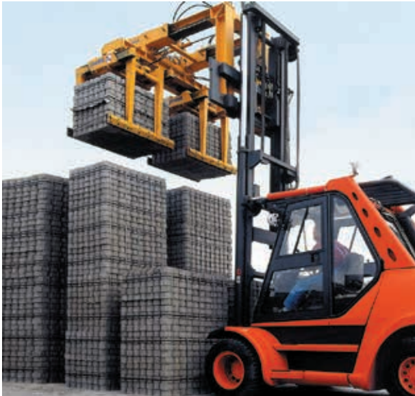
Chwytek podwójny z teleskopowo rozsuwanym wysięgnikiem żurawia STAZ-DZ-II
