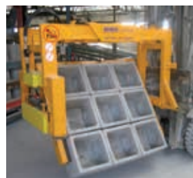
Chwytek widłowy STAZ wyposażony w obrotowe zaciski 180°
