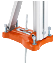
2 System kotwienia w słabej nośności podłożach
