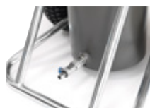
17 Przyłącze przewodu wodnego do PP 455 E
