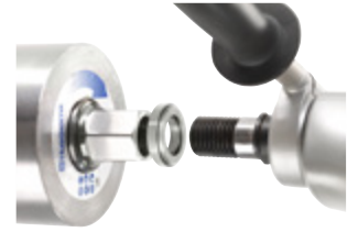
4 Podkładka antyzaciskowa ułatwia demontaż wiertła z wrzecioną silnika
